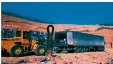
En la mayor parte de los casos la descarga se hace mediante una placa de eyección impulsada por un cilindro hidráulico telescópico. El accionamiento de este cilindro puede ser por medio del motor del camión tractor o de un motor auxiliar.
