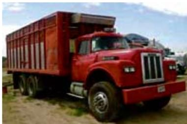
la altura de carga es muy elevada, el acomodo de los residuos dentro de la caja es manual, se requiere de un empleado adicional en la cuadrilla de trabajo. Así mismo, al adicionarle a la caja volumen hacia arriba, se eleva el centro de gravedad por encima de las especificaciones de diseño.
